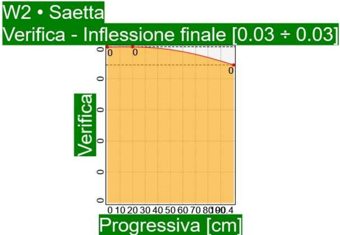
*Elemento W2 • Saetta÷Situazione di progetto 7 • SLE Quasi permanente, Permanente ÷ Inflexione finale*
