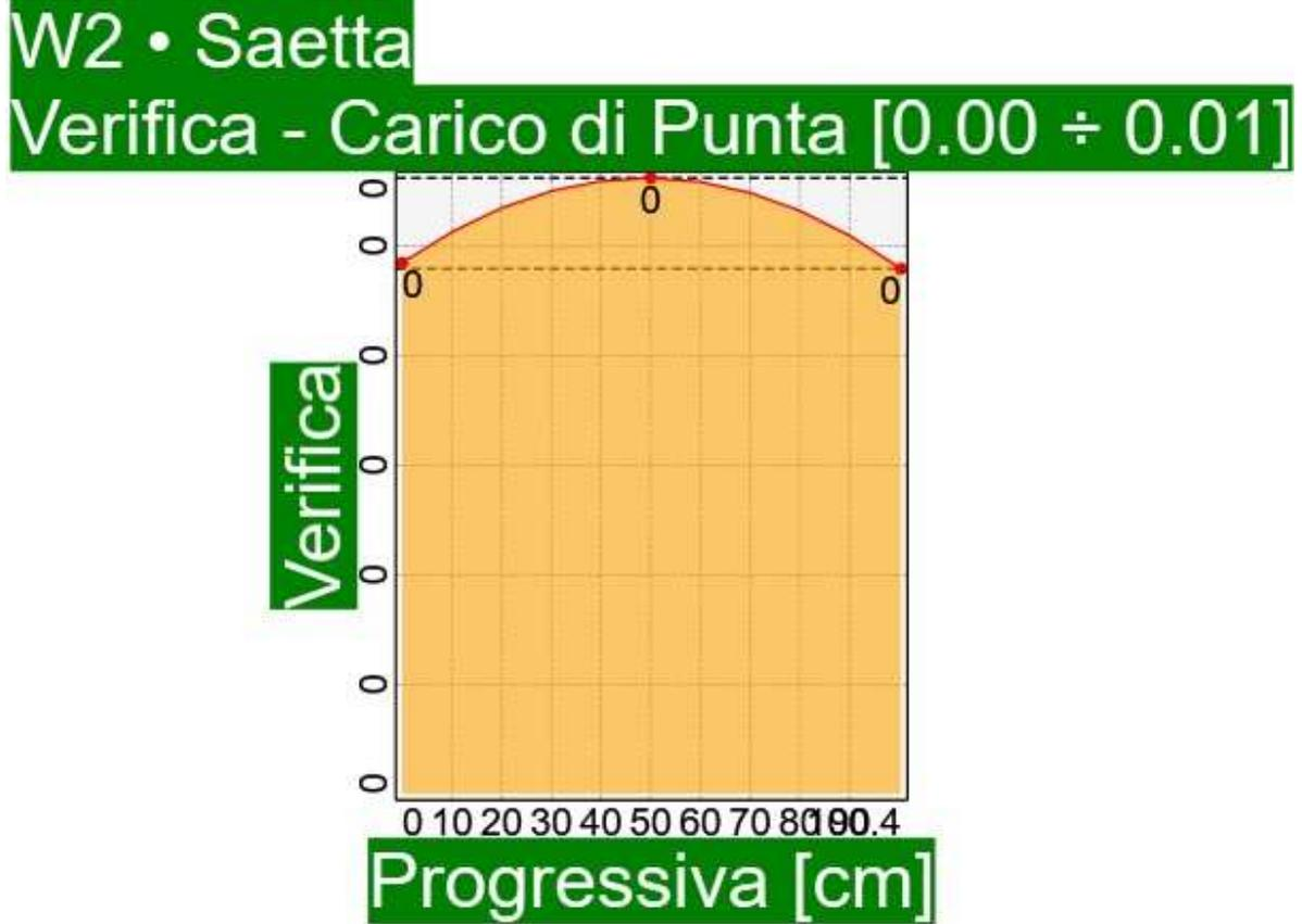
*Elemento W2 • Saetta ÷ Situazione di progetto 3 • SLU Eccezionale, Incendio R30, Permanente ÷ Carico di Punta*
