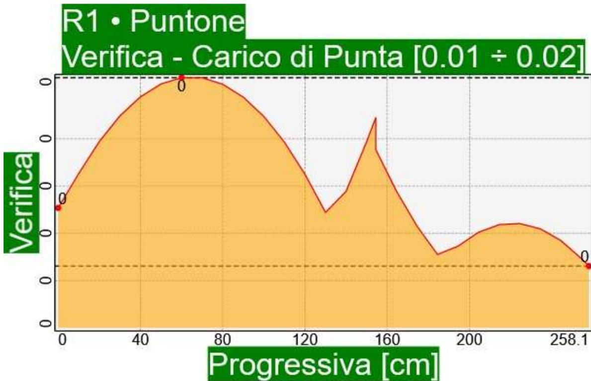
*Elemento R1 • Puntone ÷ Situazione di progetto 3 • SLU Eccezionale, Incendio R30, Permanente ÷ Carico di Punta*
