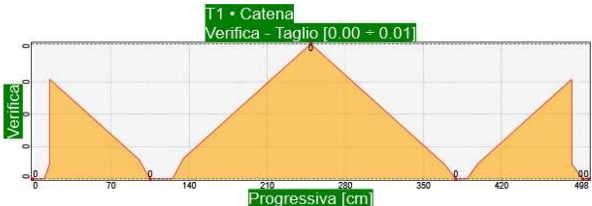
**Elemento T1 • Catena÷Situazione di progetto 1 • SLU Fondamentale, Permanente ÷ Taglio**
