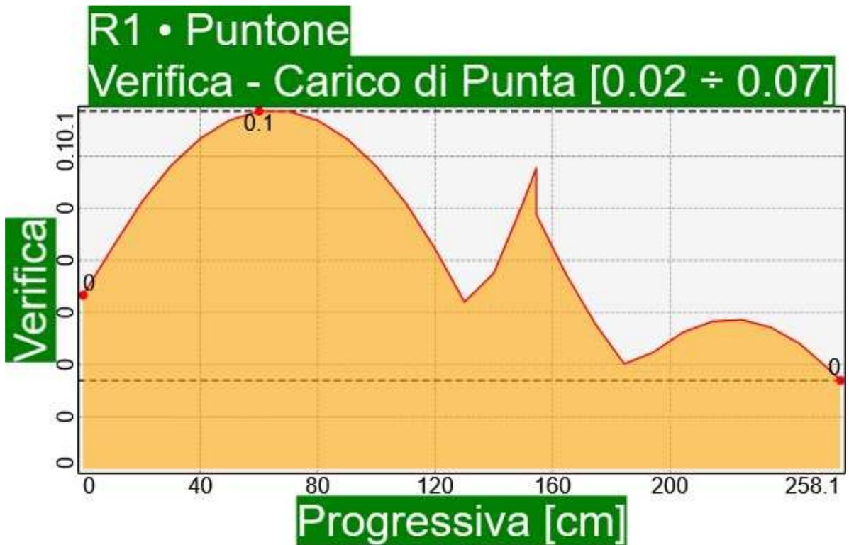
*Elemento R1 • Puntone ÷ Situazione di progetto 1 • SLU Fondamentale, Permanente ÷ Carico di Punta*
