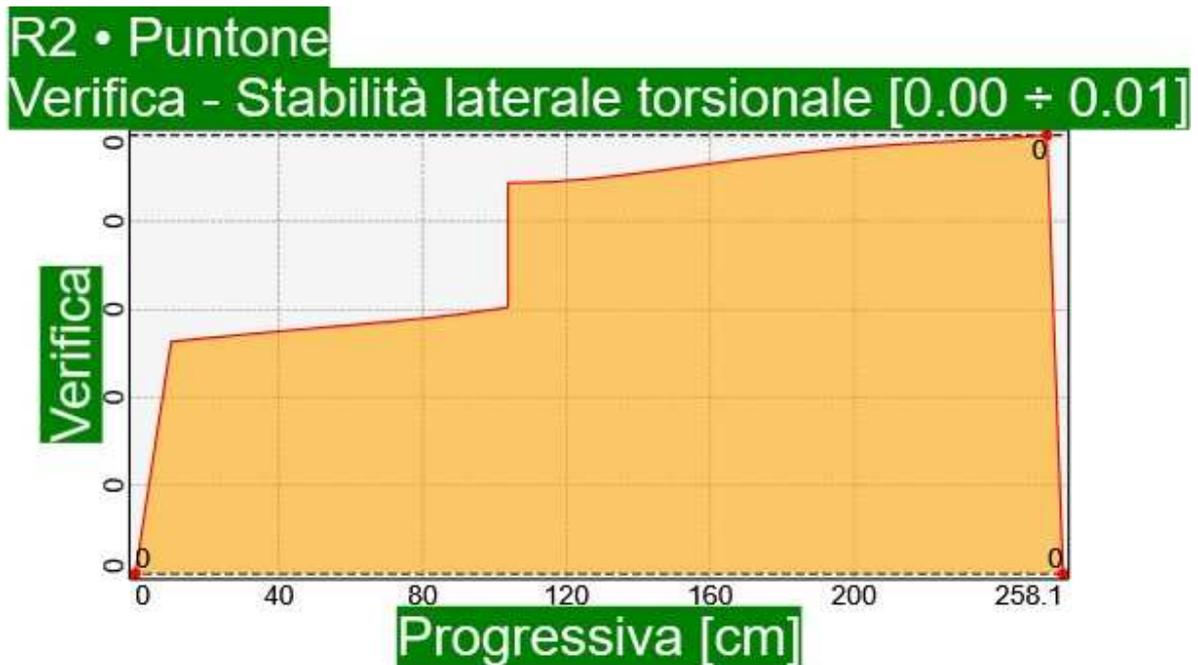
**Elemento R2 • Puntone÷Situazione di progetto 4 • SLU Eccezionale, Incendio R60, Permanente ÷ Stabilità torsionale laterale**
