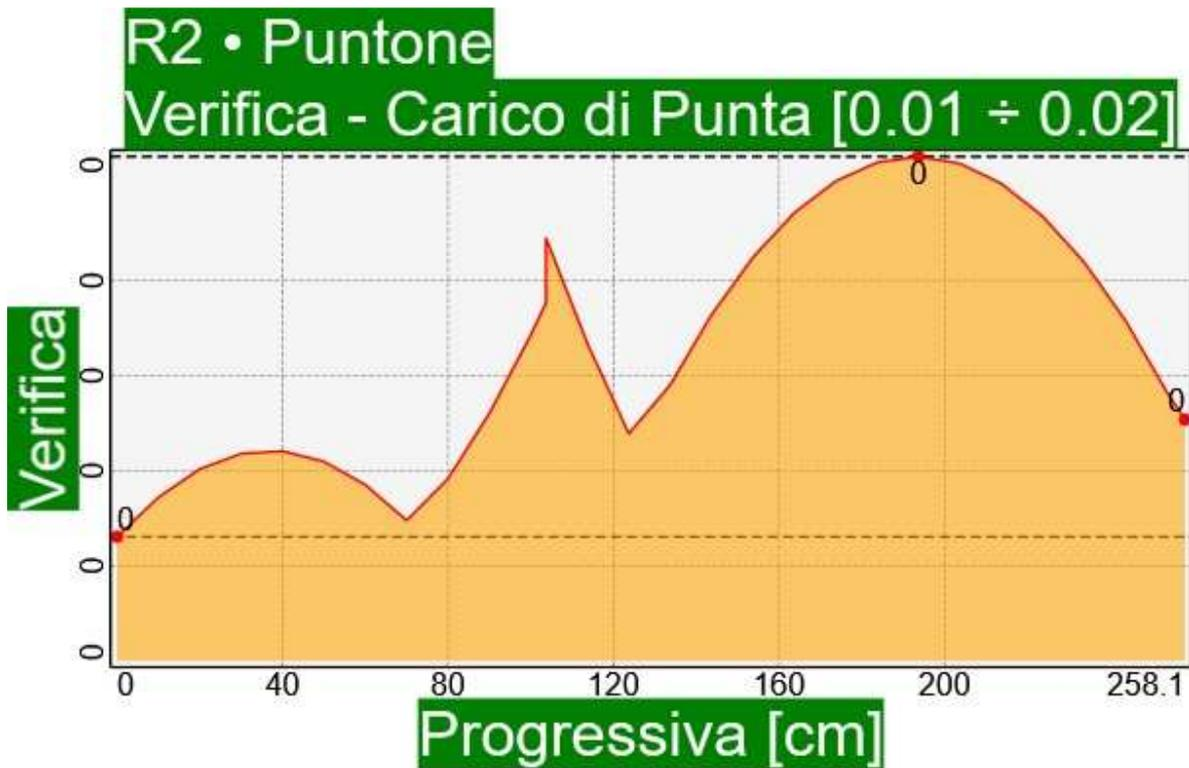
*Elemento R2 • Puntone ÷ Situazione di progetto 4 • SLU Eccezionale, Incendio R60, Permanente ÷ Carico di Punta*
