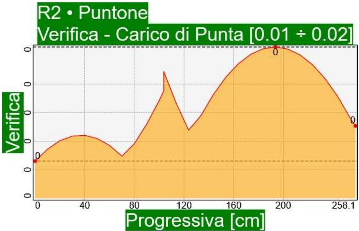
*Elemento R2 • Puntone ÷ Situazione di progetto 3 • SLU Eccezionale, Incendio R30, Permanente ÷ Carico di Punta*
