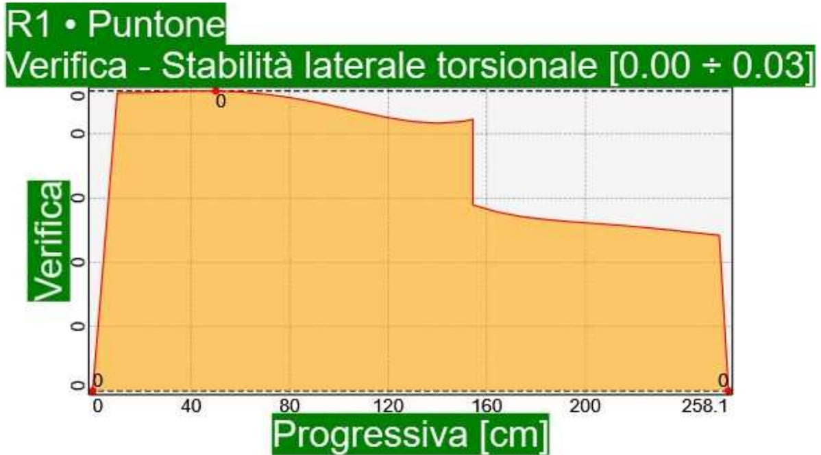
*Elemento R1 • Puntone÷Situazione di progetto 1 • SLU Fondamentale, Permanente ÷ Stabilità torsionale laterale*
