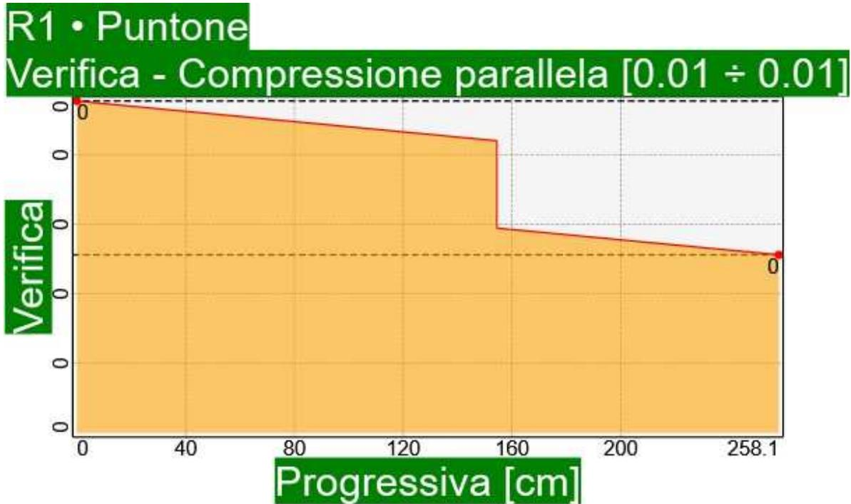
*Elemento R1 • Puntone ÷ Situazione di progetto 3 • SLU Eccezionale, Incendio R30, Permanente ÷ Compressione parallela*
