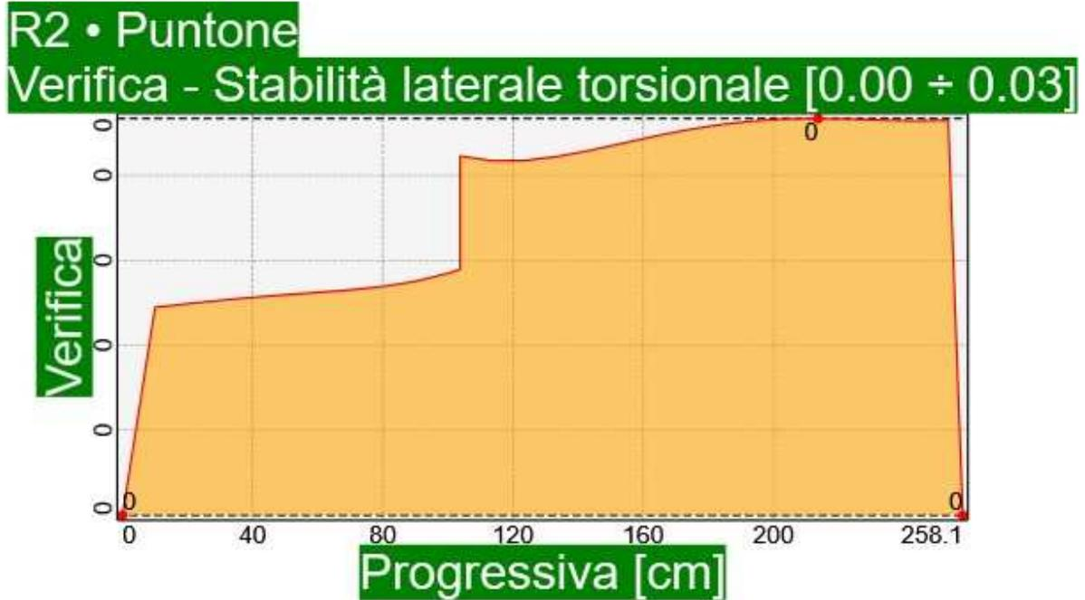
*Elemento R2 • Puntone÷Situazione di progetto 1 • SLU Fondamentale, Permanente ÷ Stabilità torsionale laterale*
