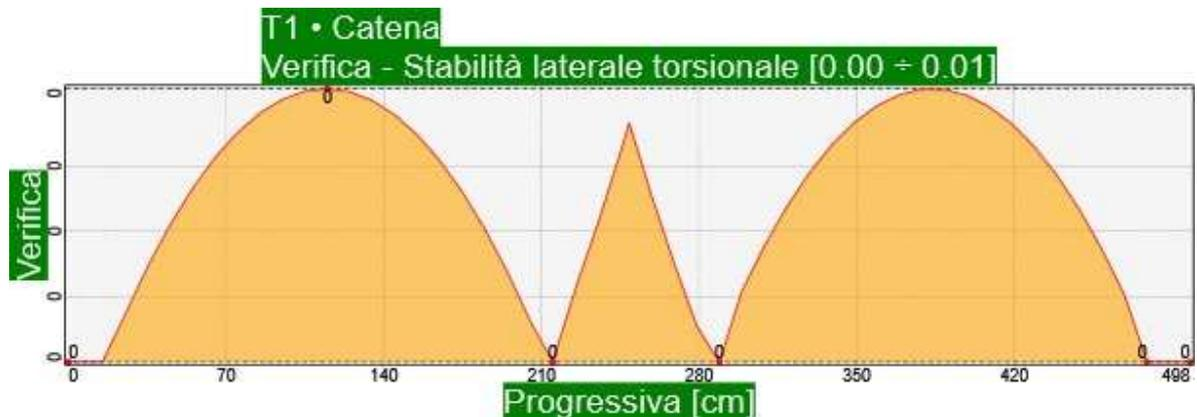
**Elemento T1 • Catena÷Situazione di progetto 1 • SLU Fondamentale, Permanente ÷ Stabilità torsionale laterale**
