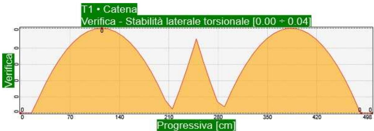
**Elemento T1 • Catena÷Situazione di progetto 4 • SLU Eccezionale, Incendio R60, Permanente ÷ Stabilità torsionale laterale**
