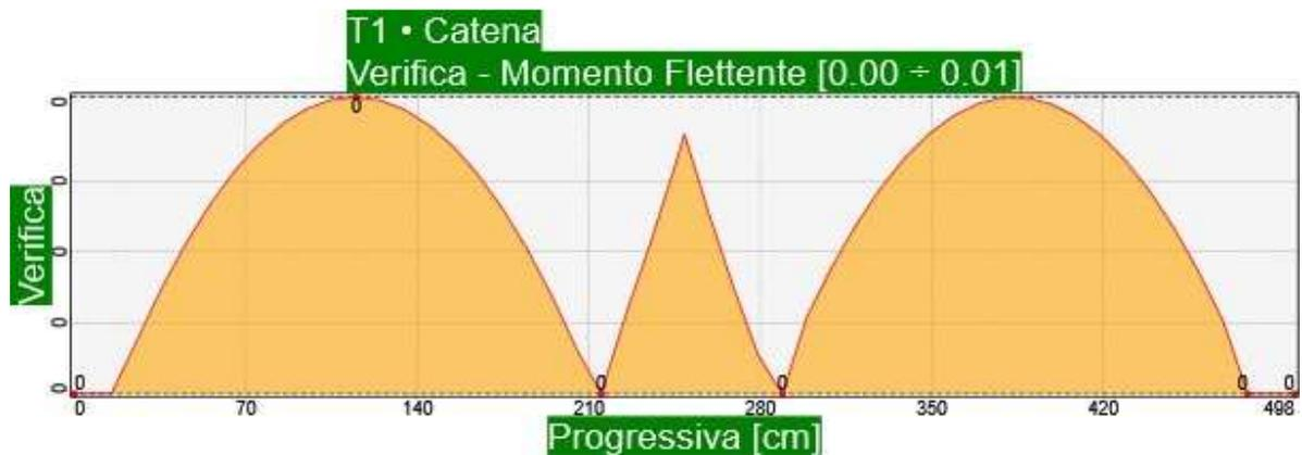
Elemento T1 • Catena • Situazione di progetto 1 • SLU Fondamentale, Permanente ÷ Flessione
