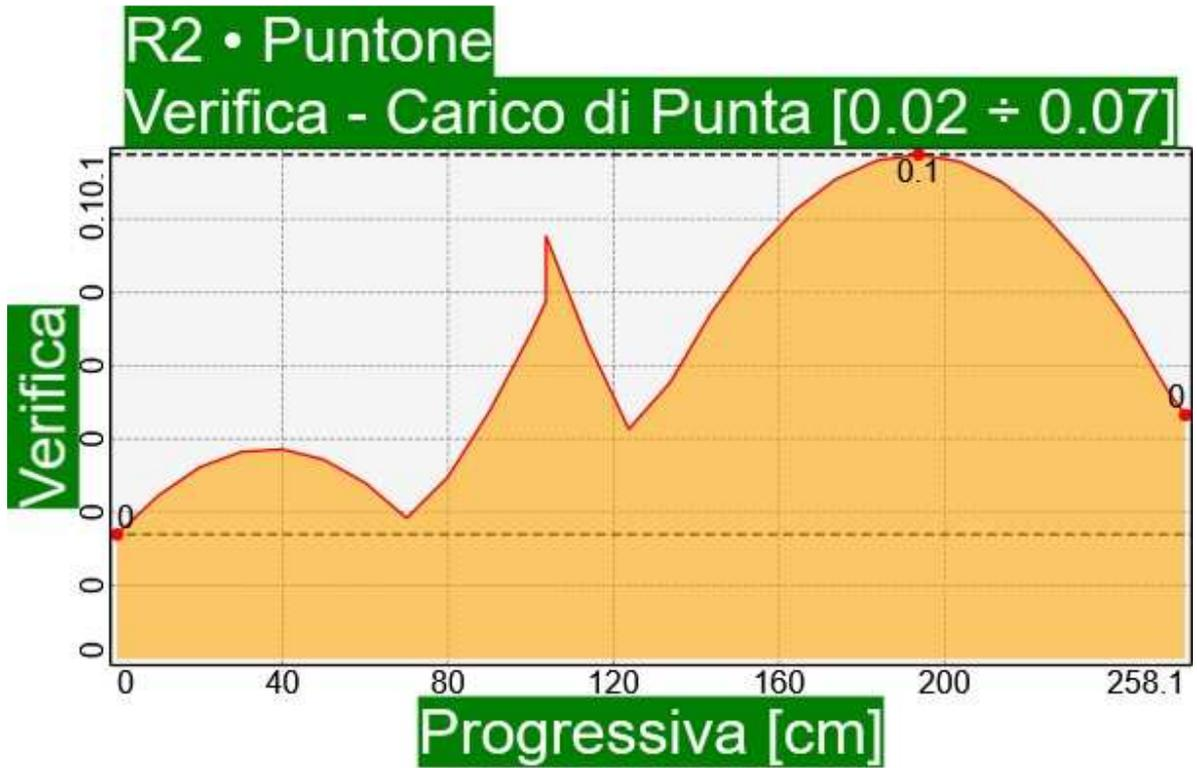
*Elemento R2 • Puntone ÷ Situazione di progetto 1 • SLU Fondamentale, Permanente ÷ Carico di Punta*
