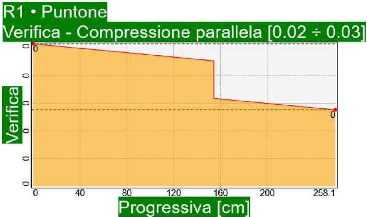
*Elemento R1 • Puntone ÷ Situazione di progetto 1 • SLU Fondamentale, Permanente ÷ Compressione parallela*
