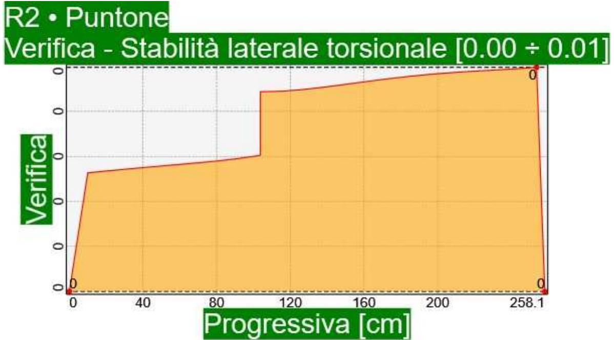
*Elemento R2 • Puntone ÷ Situazione di progetto 3 • SLU Eccezionale, Incendio R30, Permanente ÷ Stabilità torsionale laterale*
