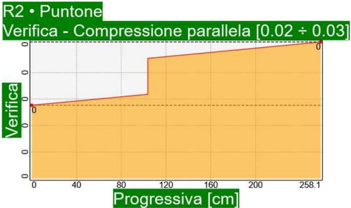
*Elemento R2 • Puntone ÷ Situazione di progetto 1 • SLU Fondamentale, Permanente ÷ Compressione parallela*
