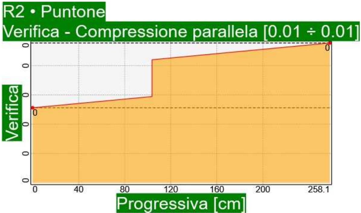
*Elemento R2 • Puntone÷Situazione di progetto 4 • SLU Eccezionale, Incendio R60, Permanente ÷ Compressione parallela*
