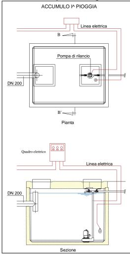
Tale impianto permette la separazione dall'acqua delle sostanze inquinanti caratteristiche di uno scarico di questo tipo, come oli minerali, idrocarburi leggeri, sabbie e terricci.
