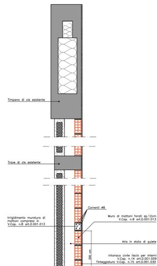
**SEZIONE TIPO MURATURE PERIMETRALI E COPERTURA BLOCCO SERVIZI DA REALIZZARE**
